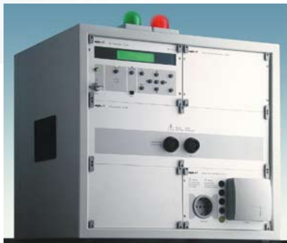
CANclass Compact Tester modello TS1.300D, strumento di prova a norma VDE0700 con potenza di 500 VA. Prova di alta tensione 0-5 kV AC, 0-7 kV DC, prova di isolamento da 0-1000 V DC, prova di conduttori di protezione 5 fino 30 A. Corrente di lavoro mono o trifase.
