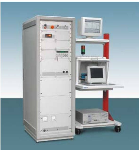
Sistema di test automatici con prove di alta tensione, isolamento, conduttore di protezione e corrente di fuga. Misurazione integrata della potenza, corrente assorbita e molte altre. Completo controllo in rete tramite software di test CANDY. Alta tensione fino a 6000 V AC, 7000 V DC.
