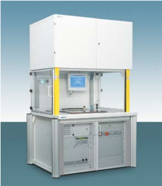
Sistema di test automatico per il collaudo di sensori. Prove d'alta tensione e d'isolamento con matrice di relais a 32 punti, prova di dispersione e d'isolamento. Completo controllo automatizzato di tutti i contatti pneumatici con le più moderne tecniche di sicurezza.
