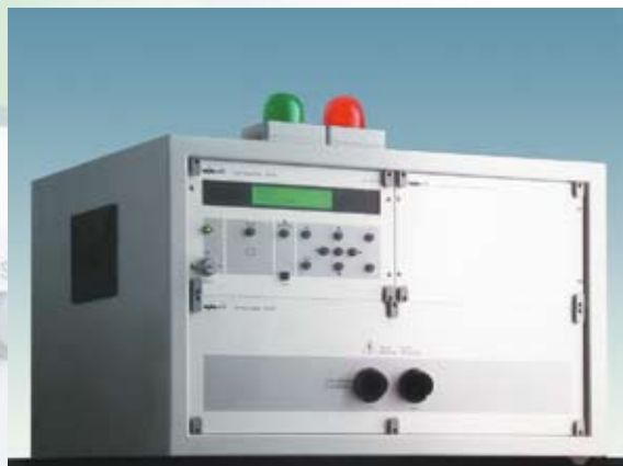
CANclass Compact Tester modello TS1.200, strumento di prova a norma VDE0113 con potenza di 500 VA, strutturato per future espansioni. Prova di alta tensione 0-5 kV AC, 0-7 kV DC, prova di isolamento da 0-1000 V DC, prova elettronica di sicurezza da 5 a 30 A.
